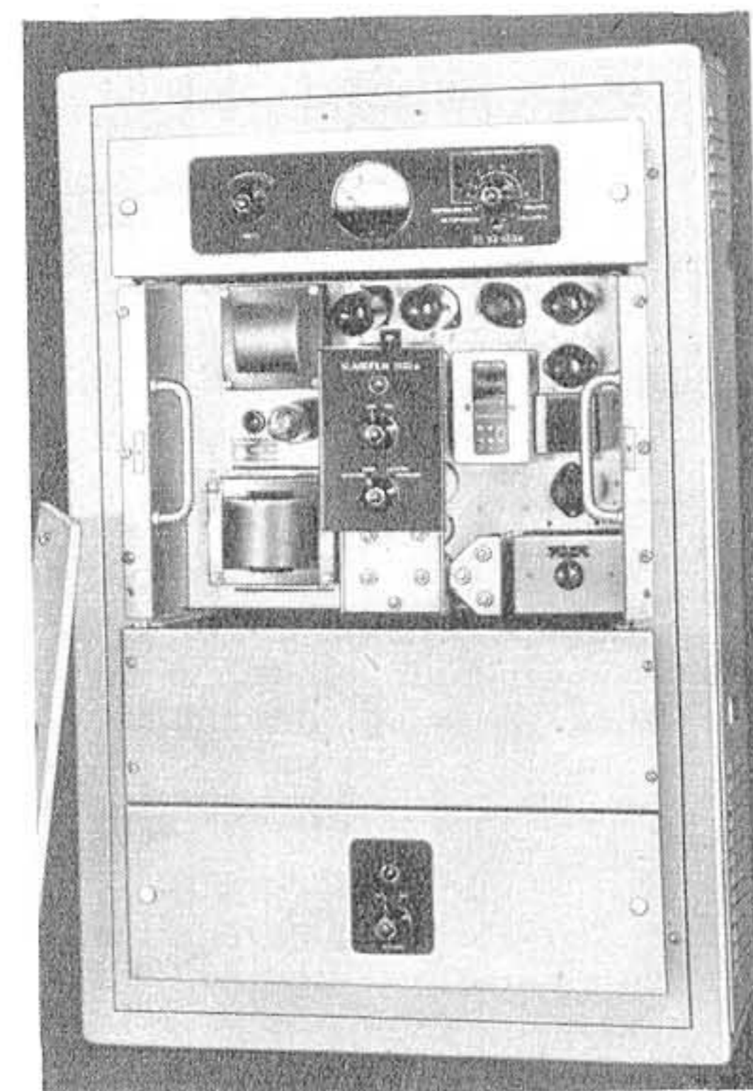
Eurodyn-Gestellanlage M — AZ 404. Abdeckblech für den Verstärker Kl. V. 402a abgenommen, Röhren, Entzerrer und Fotoausgleich sind sichtbar
